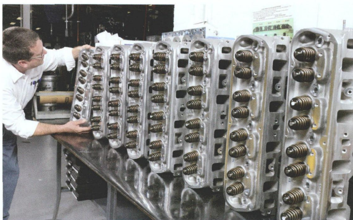
图 4 车间主管 Roger Burkel 检查排气缸盖
