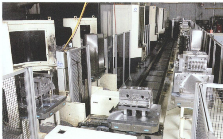
图 2 三个 Makino a81 水平面附在在 20 货盘 MMC 自动化材料处理系统内，按照高混合低容量的生产序列改进其弹性
