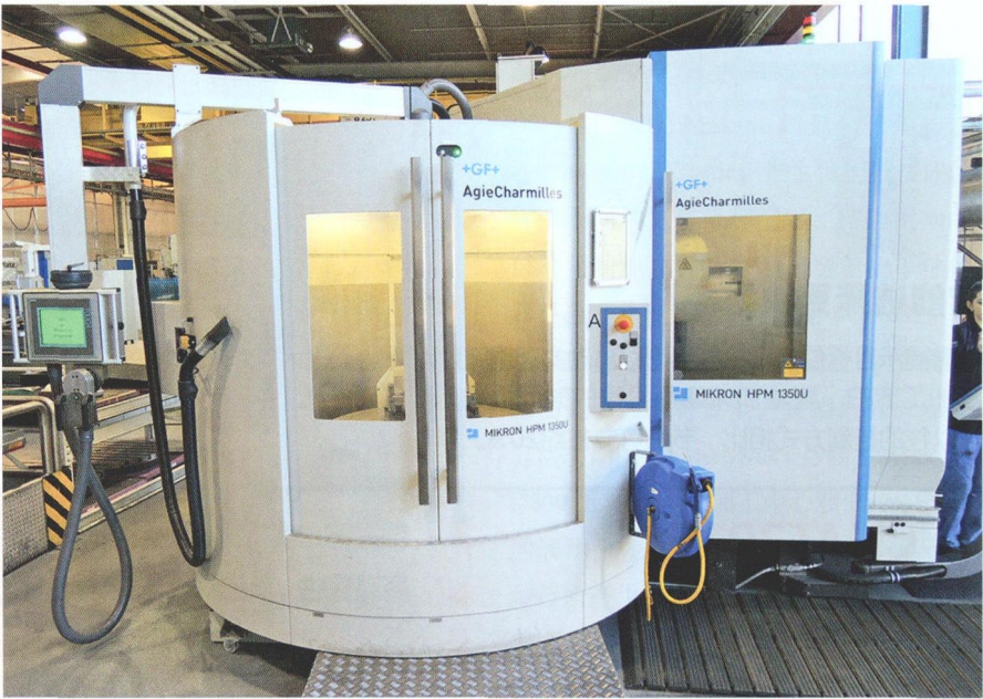
在为模具和刀具加工小件时，带有刀具和托盘更换装置的两台 Mikron 加工
