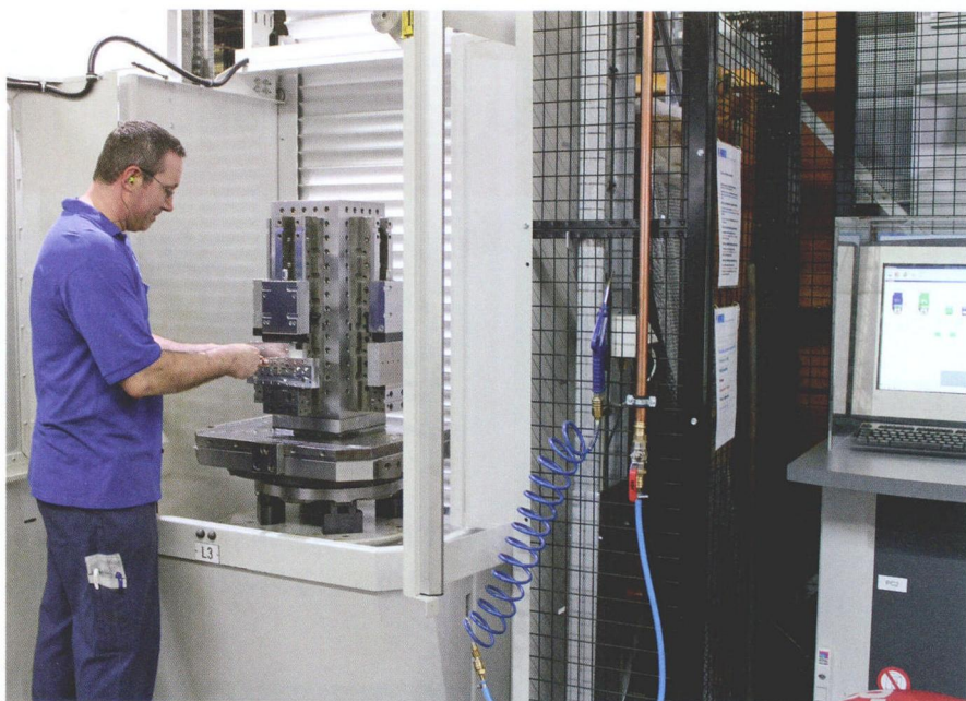
图 2 加工中心的上料工位有着更多的空间用于装卡工件
