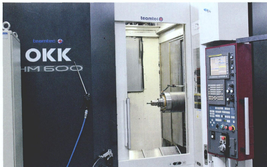
图 1 利用两台相同的 HM 600 型加工中心把高精度零部件的加工提高到了新的水平——这种数控机床的配置方案以其非常好的刚性而著称
