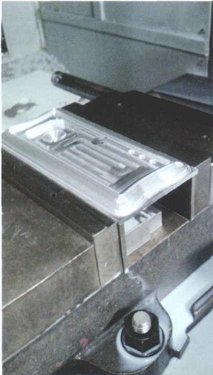
图2 加工一块 1.25 in 厚 × 11.25 in 长 × 6.75 in 宽的顶板，加工程序的尺寸和主轴转速都最适合使用这台 Feeler 机床加工
