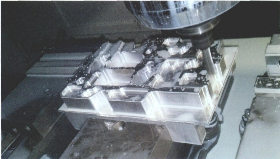
图3 在带有自动关机功能的这台 Feeler 机床的帮助下，Sarro 公司能够在熄灯条件下无人值守地实现这块端板加工作业 8h 加工
