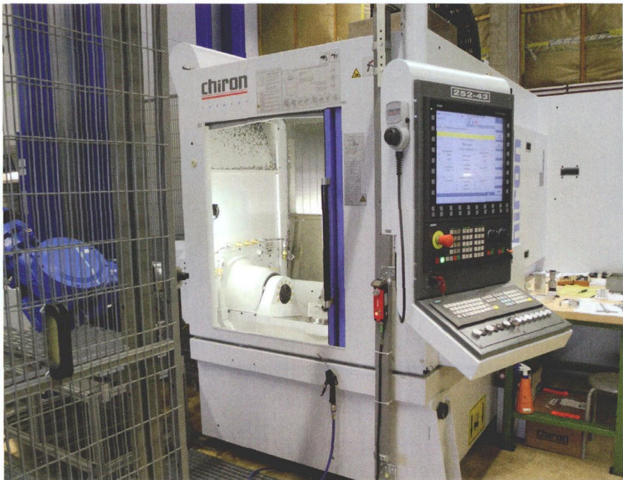
图 1 自从购置了 Chiron 公司研制的 FZ 12 FX 5 轴加工中心和 Goodj 公司的自动化技术方案后，瑞士精密机械加工股份公司便可在夜间以无人操作的方式完成客户的工件加工
