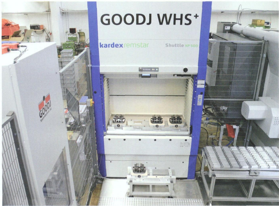
图 3 集成化的塔式工件存放装置，除设备外，还堆放着托盘，也可从后侧装卸加工工件
