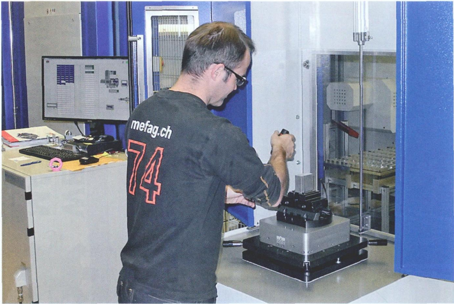
图 4 操作工人有一个自己的专用作业点，可在设备旁进行张紧夹具的安装和调试，在该作业点，工作人员在设备外进行操作
