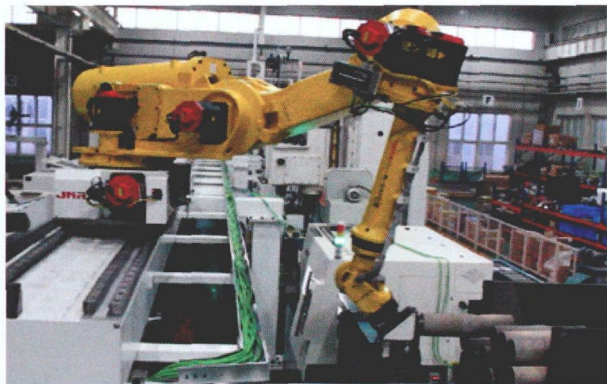
图 1 该柔性自动化生产线集工艺、设备、立体仓储、AGV 小车等技术为一体，实现了缸套制造自动化生产
