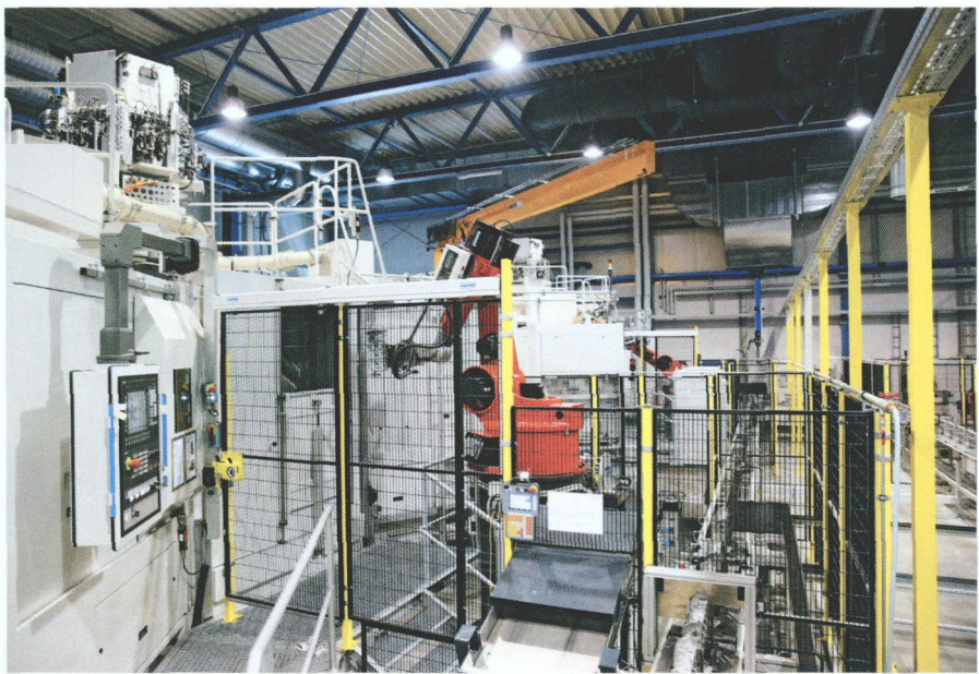
气缸盖罩加工设备通过一条传送带连接在一起，各使用一个机械手上料
