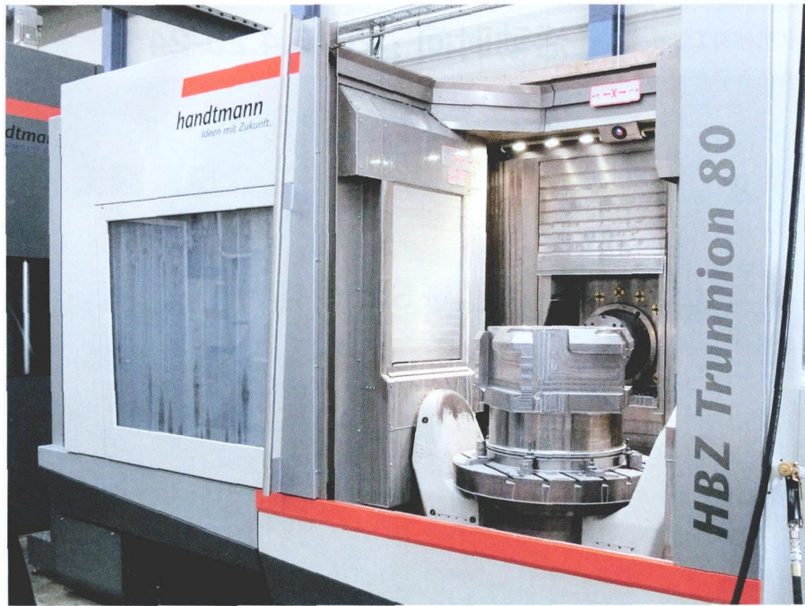
图 1 LARO 公司引进的第 1 台卧式加工中心海德曼 TR 80 型机床，该机床可加工铝、钢、硬质合金以及钛合金等材料
