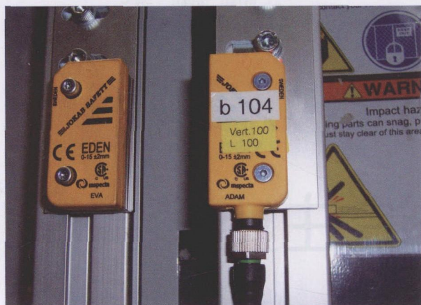
图4 这种安全传感器开关距离为0 ~ 15 mm, 操作角度为0 ~ 360°, LED 闪率用于辅助校准
