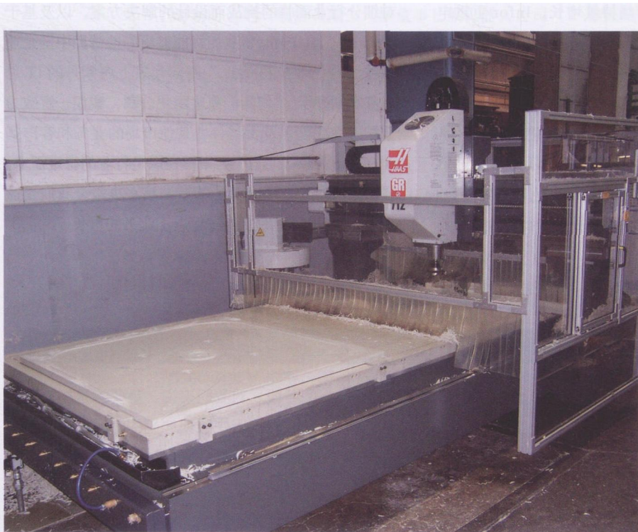
图 1 这台用于加工聚丙烯制成的过滤器板坯件的铣床补装了安全综合方案
