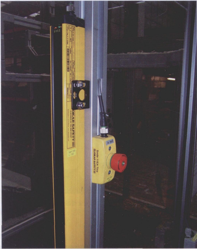
图 3. 这种安全光幕截面仅为 37 mm × 48 mm，保护区高度为 1500 mm。后面是带 M12 插头的紧急停车键以及 LED 显示器
