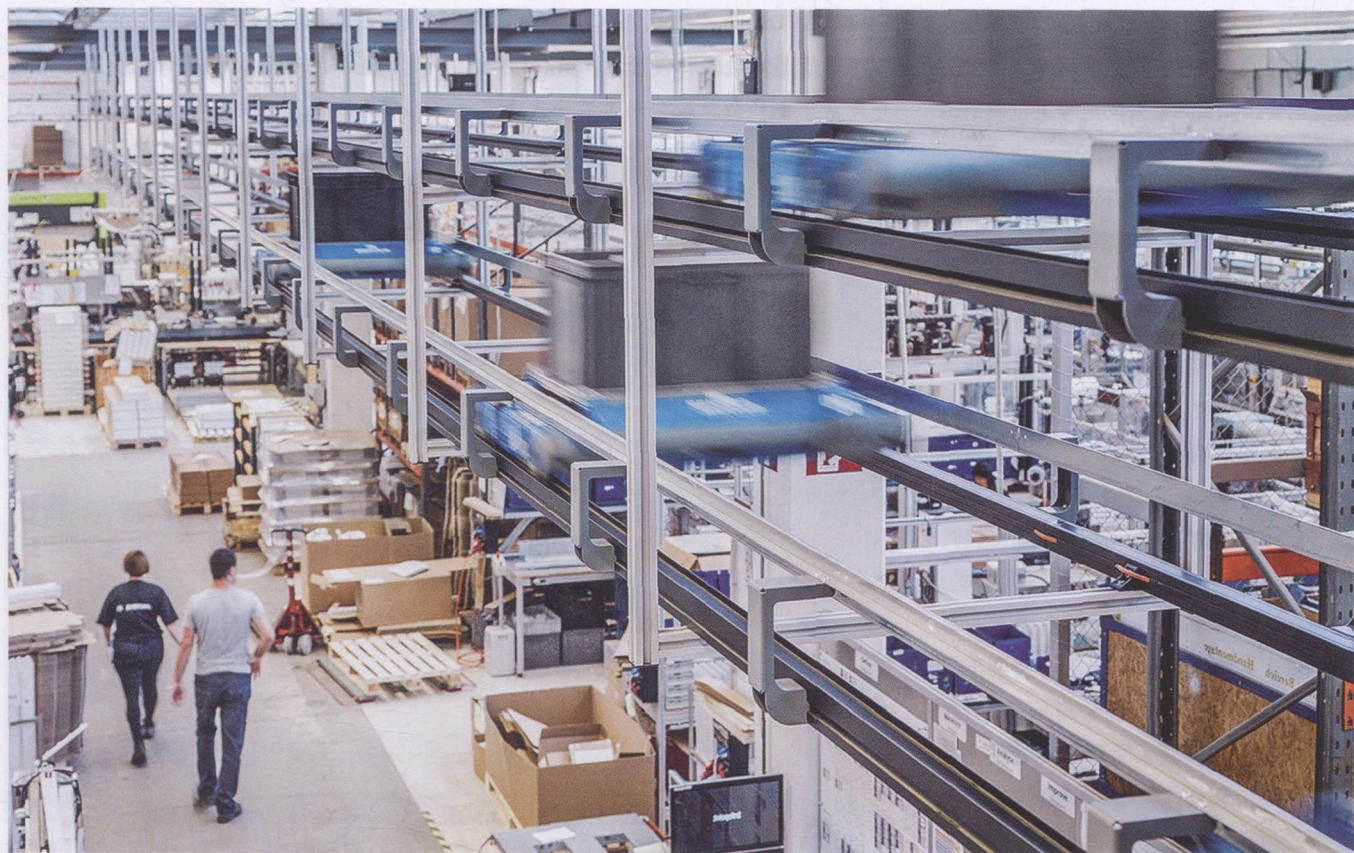
Servus 分段系统可以个性化的灵活安装在符合人体工学的工作高度
