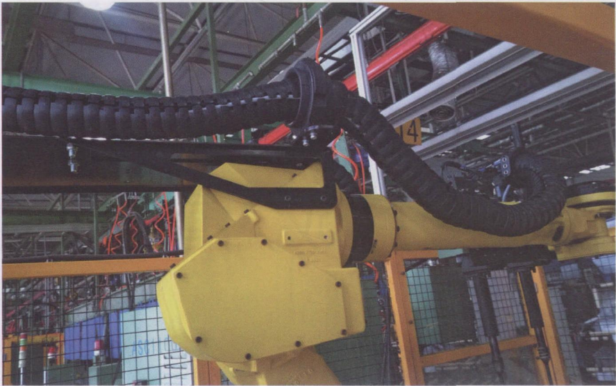
图2 采用Triflex R系统改造后，电缆贴近机器人，同步运行，磨损极低，安装空间大幅减少
