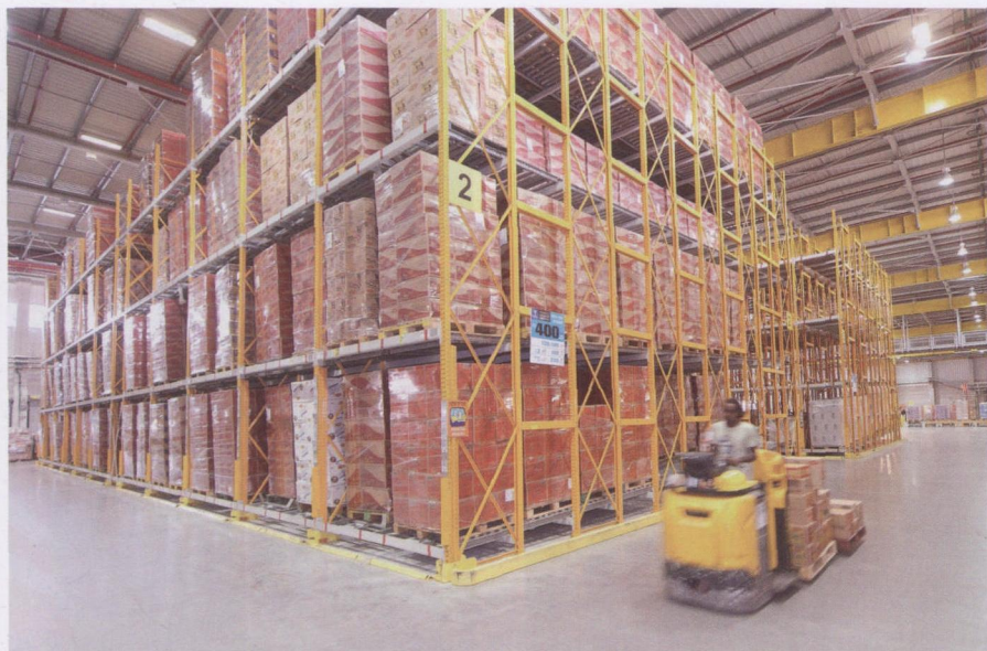
图 4 Osem 公司在—个与快速旋转器相匹配使用的连续运行的货架里有 2500 个托盘放置位
