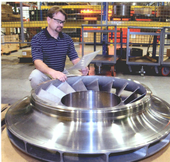
图 1 转子部机加工主管 Ron Topper 仔细检查一个大型离心压气机叶轮。很多该部门生产的零部件都是 80 in 大直径的部件
