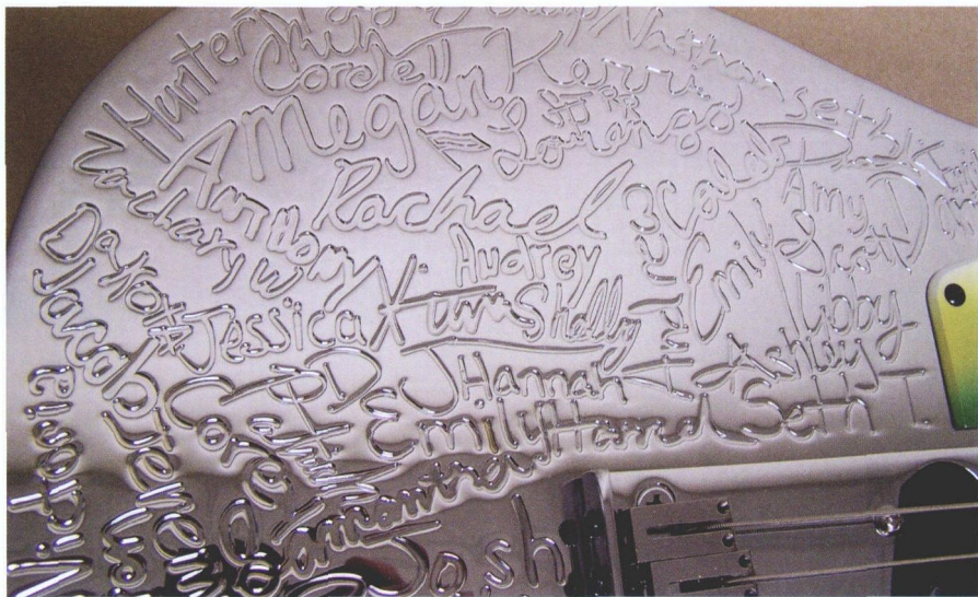
图 3 Mastercam 软件通常用于雕刻扫描设计的刀具路径，由客户创建至乐器表面内
