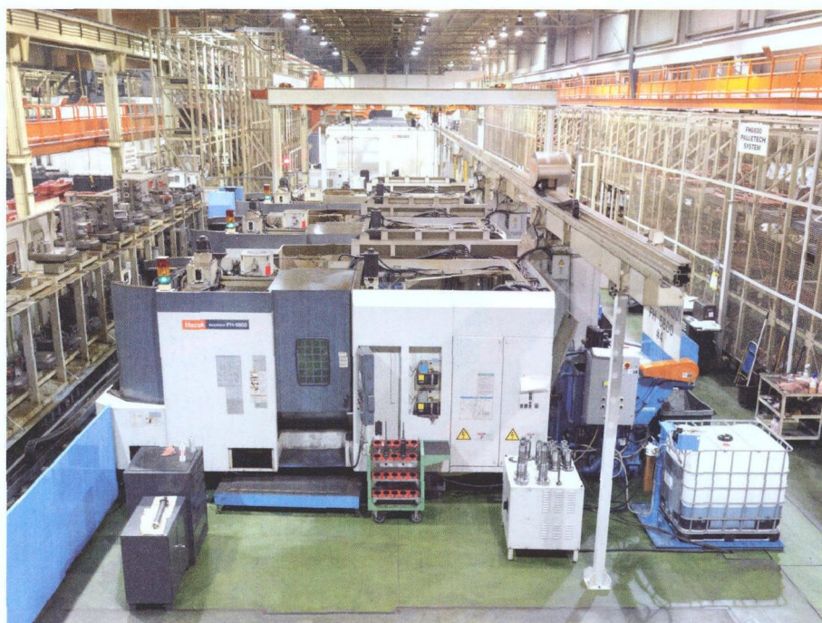
图 1 在这一 Pallettech 柔性加工系统上，一套 MTConnect 驱动的机床监控系统，可提供生产线上三台 FH6800 型卧式加工中心工作性能的实时报告。目前，许多其他机床也正在与这一监控系统连接，不久将在整个工厂范围内操作运行
