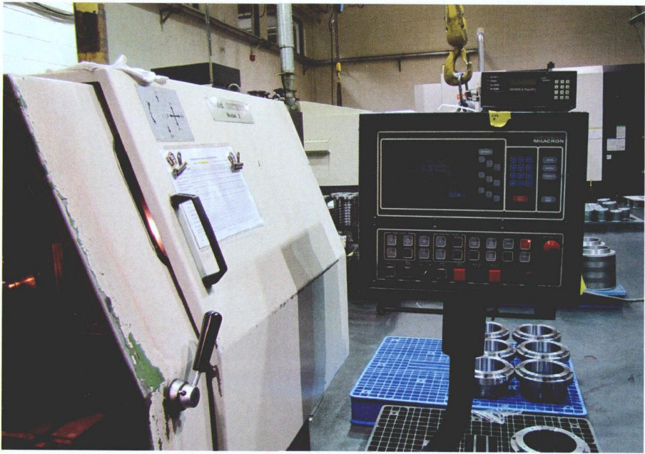
图 2 这台老式磨床可作为传统机床与监控系统连接的一个具体实例，他们通过一个安装在控制单元内的 MTConnect 适配器相互连接
