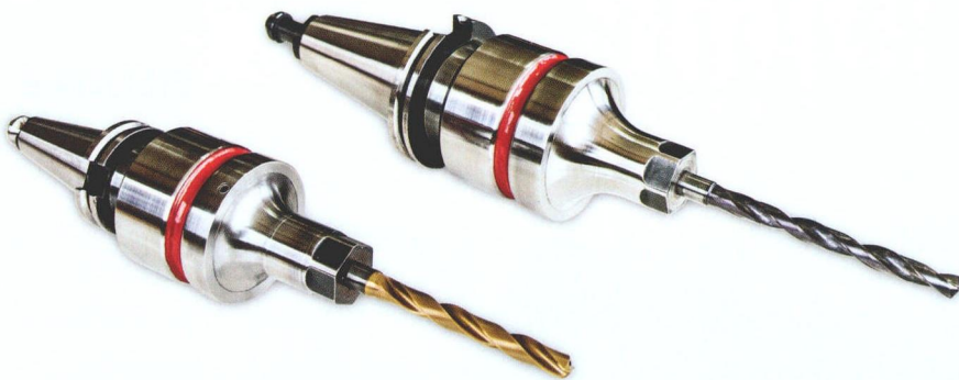
图2 尽管所有钻头和端铣刀都可以配合 Acoustech 系统,但刀具必须根据所适用的频率进行动态微调,这种微调通过对刀具伸出长度的调整来实现,可以适用各种不同的伸出长度,其范围为 3.5~6 in,因此,这套系统一项较不寻常的要求就是需要在刀具设置时将此项因素考虑在内
