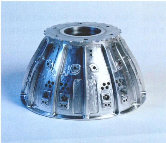
图 1 机匣加工时对于切削要求非常高
