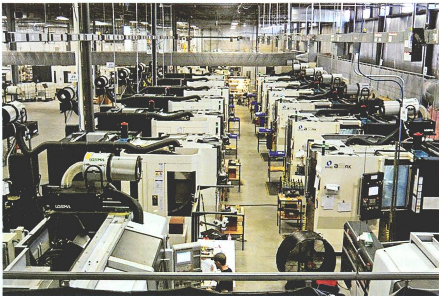
图 1 由 32 台 Makino a51nx 卧式加工中心组成的生产线，机床在相同的指导原则下运行，注重细节，力求确保加工精度的一致性
