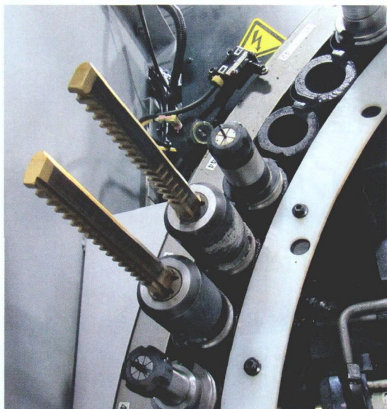
图2 卧式加工中心整合推削加工是可行的，因为推削刀具可以装到刀库中，并作为拉刀使用
