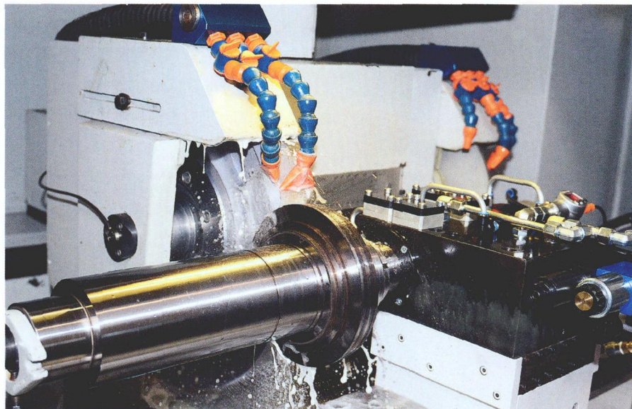
图 1 Hyprostatik Schönfeld 公司的磨削加工设备采用了液力静压的支承方式，可以实现圆跳动公差为 0.2\text{ }\mu\text{m} 的磨削精度
