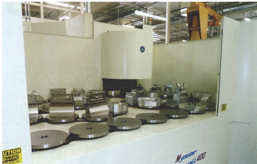
图3 这个配备 40 站托盘系统的 Supercell 400 机床可以将一些托盘上的夹具保持原位不动，同时又可释放其他一些托盘用于执行新的作业
