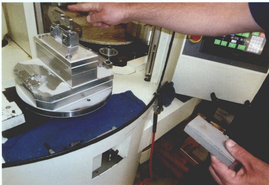
图 4 用 3 种不同夹具加载到托盘上的坯料，让这个部件能够在同一个托盘上完成全部加工作业
