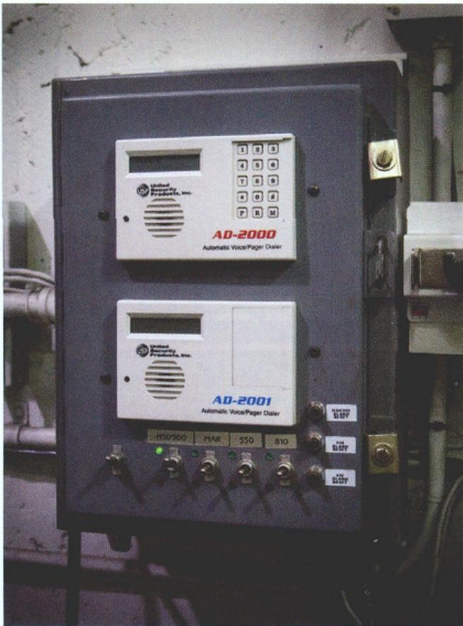
图4 在现有机床上增设拨号上网硬件让 CNC 加工中心能够在需要提醒注意时向 Byrne 员工发送文本短信
