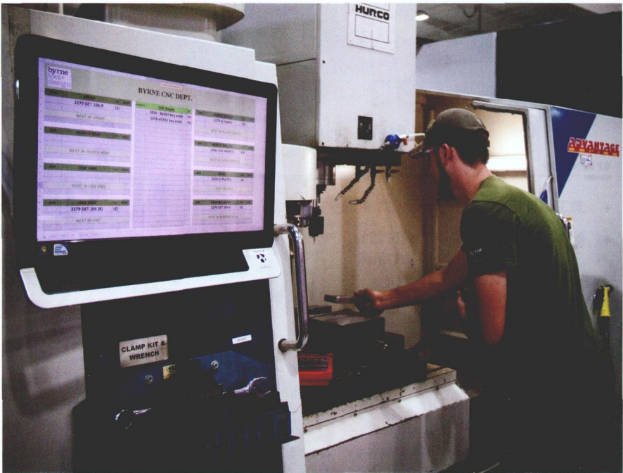
图 1 Byrne 公司的加工中心机身是将作业信息通过 Google Docs 显示在触摸屏显示器上，因为这样出来的文档不会被弄脏或撕破，而且可以通过云共享这些信息并随时保持在最新状态下
