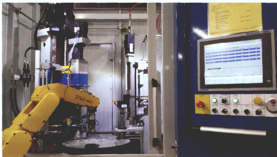
图 3 Nagel's Eco 40 兼有工件的搬运、珩磨和后处理计量的功能
