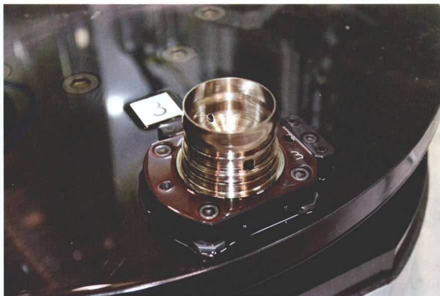
图 1 加工镀镍的喷油器罩因为其尺寸和表面粗糙度参数十分严格，是一个很难控制的过程
