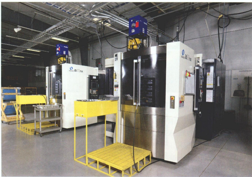
图 1 马修斯公司投资购进两台 a51nx 卧式加工中心使得公司能够解决之前机床限制问题的同时，也能够提高生产力
