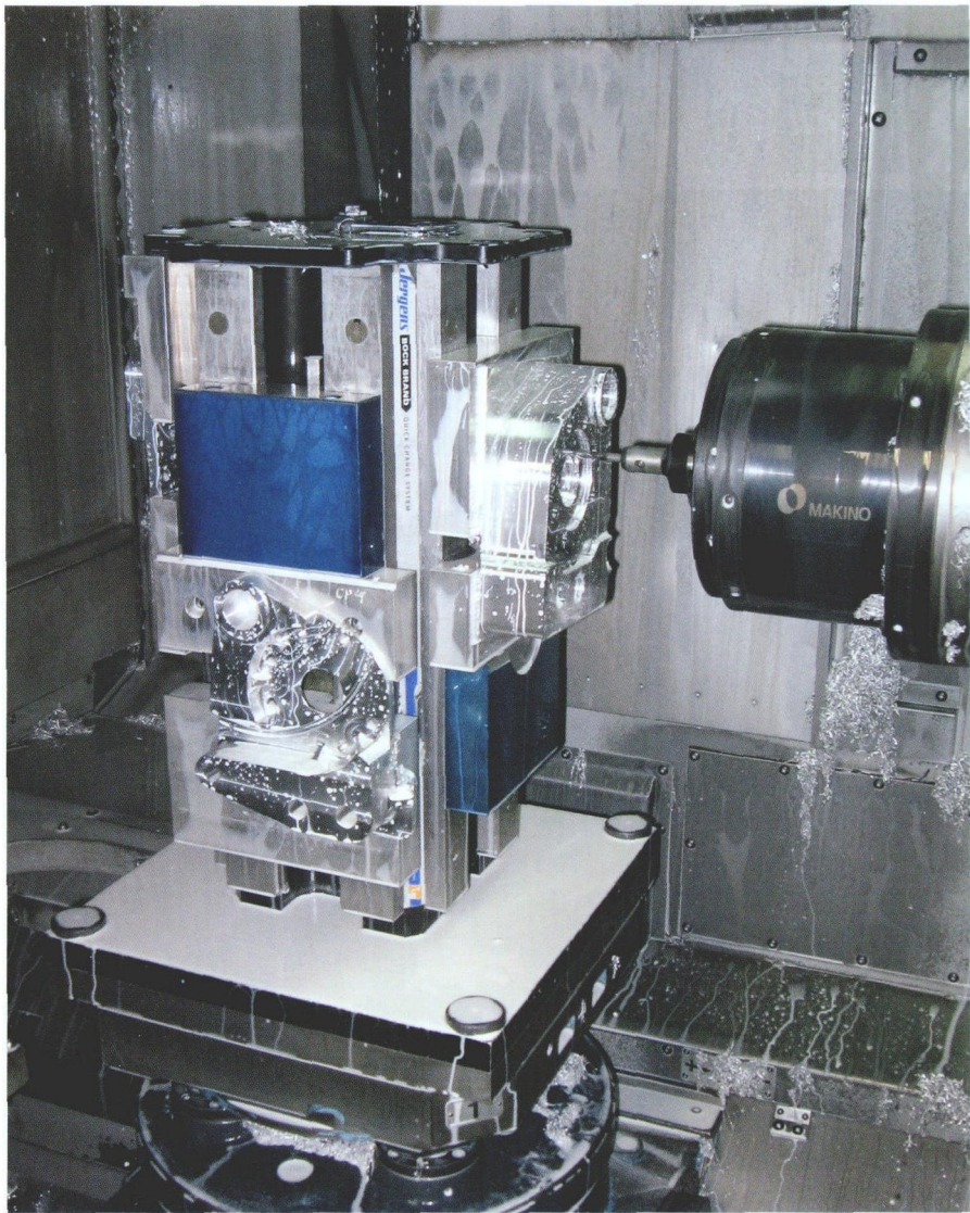
图 1 卧式加工中心的一项高效优势是可以单次装卡就加工好一个部件的各个表面，而 Advance CNC Machining 公司认为其好处远超于此
