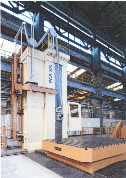
图 2 高精度的静压导轨滑枕
