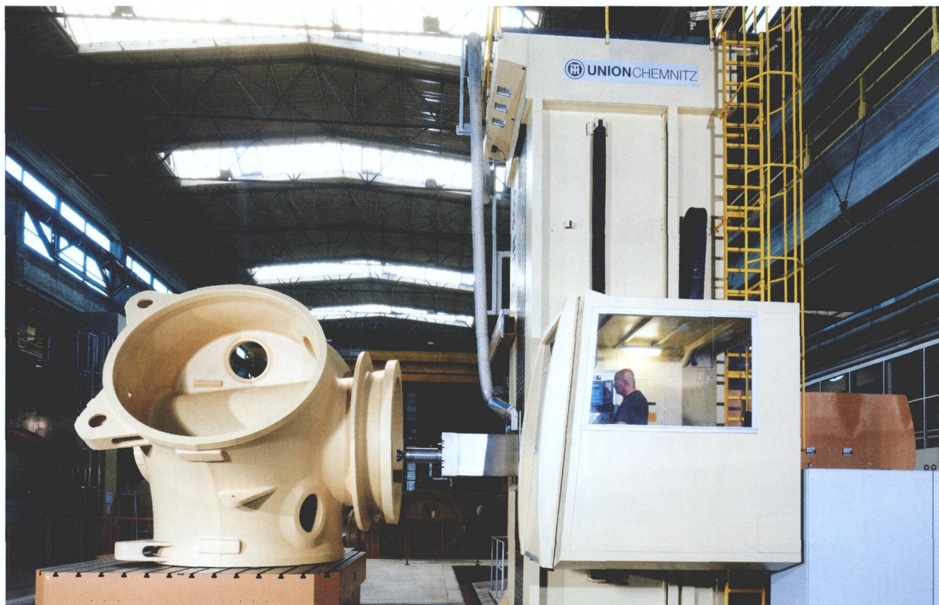
高强度的回转工作台可承载重达 75 t 的工件
