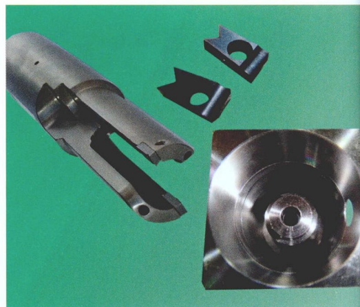
图 2 特种掏槽刀具的直径为 28 mm，它配备有两个 5 mm 宽的可更换刀片
