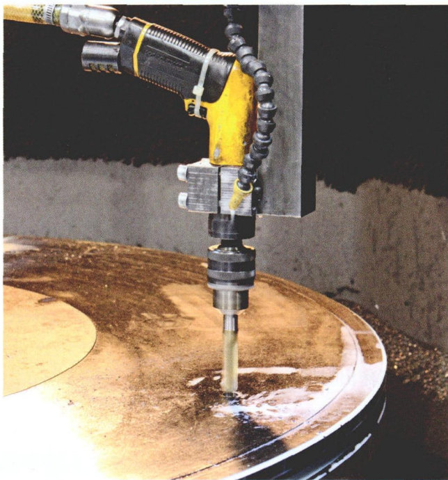
图2 通过在加工设备上内置手持钻具，可以省去另一个加工工位的中间输送环节及其成本
