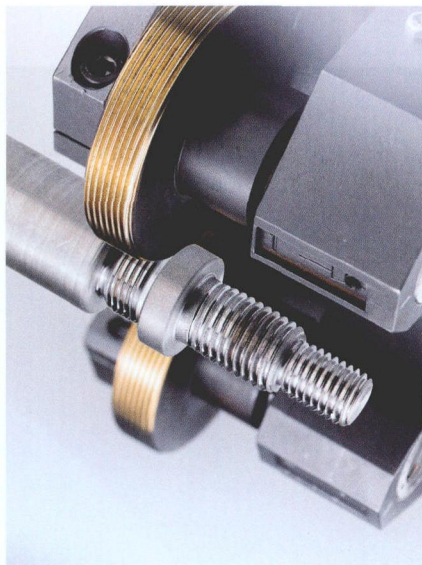
图2 切线螺纹滚压头也能加工轴环后面的螺纹
