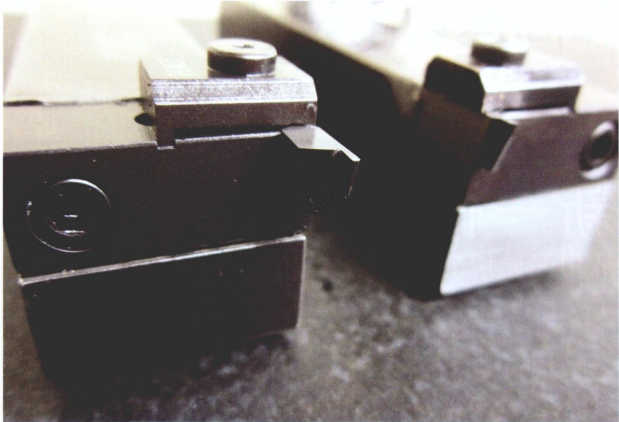
图 4 Christensen 先生之所以欣赏 Thinbit 刀具的另一个原因是，可用同一个刀夹容纳右手和左手镶件以及面削沟槽镶件
