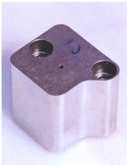
图3 硬度为 53~54 HRC 的 1.2343 耐热工具钢刀具，使抛光工序成为多余
