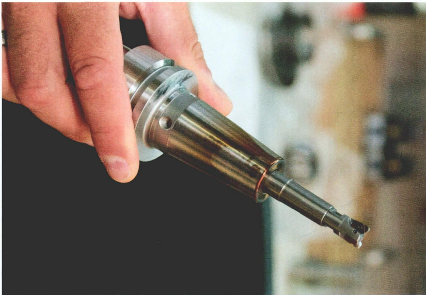
图4 采用 ASPV-Mini 型曲面转位刀片铣刀，可以对最终尺寸进行一次性精加工
