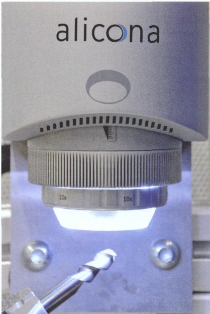
图 4 为了分析精加工刀具的微型外形几何尺寸，人们选用了一坚实耐用的高分辨率的光学测量装置
