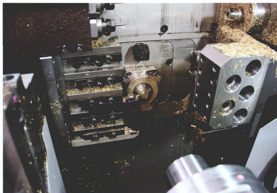
图 1 在针对复合加工应用进行测试时，TMAC-MP 刀具监测系统采用了一台配备副主轴的瑞士型车床作为试验装置。主轴上采用了一个刀库组块，静止刀具在副主轴上执行最终加工，这两个刀具部分可同时作业
