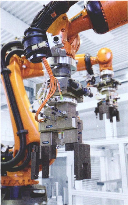
图 2 在转向台上，另一台夹具从下部抓住部件并把它放进板条箱里
