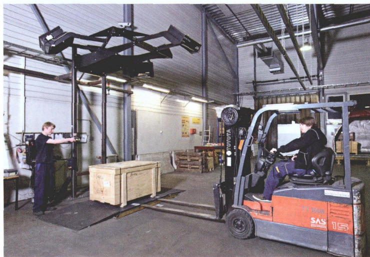
图 2 特别是在上面行驶的地磅适用于测定沉重货物的重量
