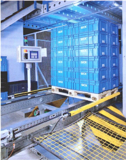
图 3 不管在 I-Punkt 点上使用的是条码扫描仪、二维码阅读器还是 RFID 系统，由于有了 ID-Pro，无论是集成平台，还是现场总线的连接技术，采用 CDF600-2 对所有的技术都是相同的
