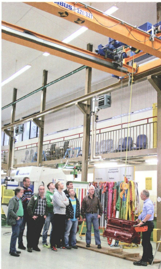
图 2 Abus 双梁移动式起重机作用距离 7 m，承重能力 3.2 t
