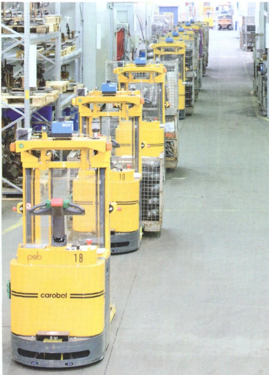
图 3 Eberspächer 公司的诺伊辛辛工厂总共用 26 台 FTF 运输板条箱和货运托盘
