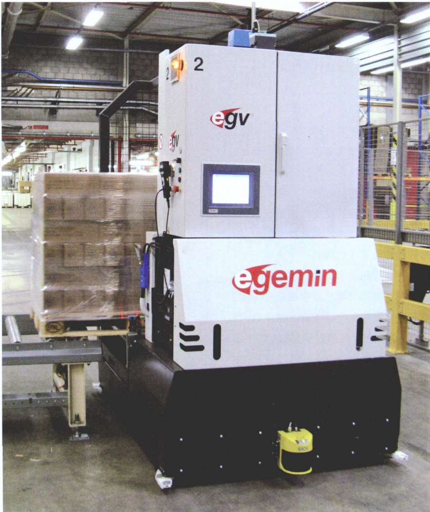
图 1 弗赖堡辉瑞 Pfizer 制药厂正在使用 Egemin 无人驾驶运输系统 (FTS)
