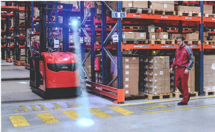
“蓝点”技术在叉车前后数米投射出一个很大的蓝色光点，是目前市场上最为有效且环保的警示方式
