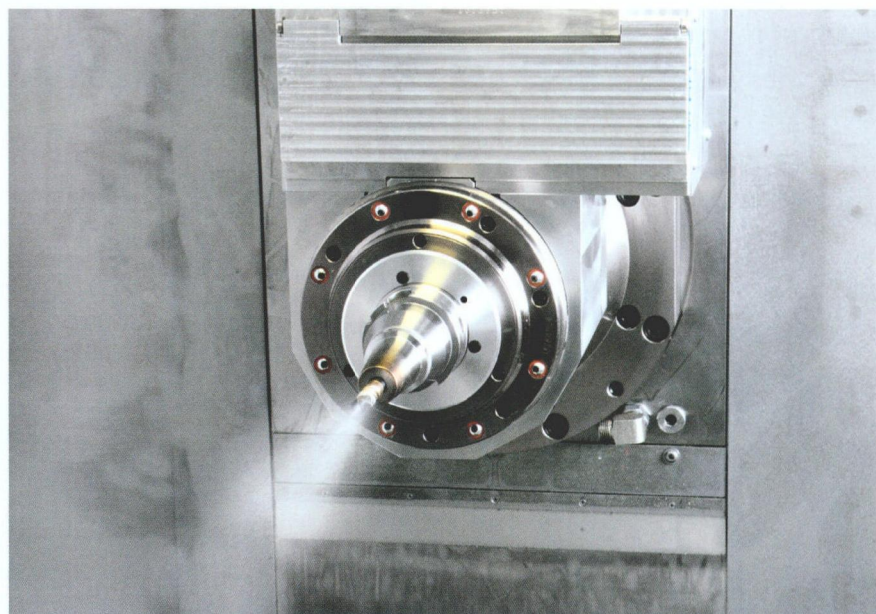
图 1 针对 CO 2 冷却加工而配备的 Starrrag 铣削轴，由此可以在加工过程中在不同的冷却工艺之间进行转换
