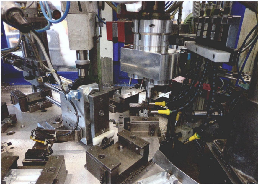
图 3 环形加工设备对螺纹进行水平（在后部工位上）和垂直的加工。后一个工位可以根据需要采用一款四轴加工设备进行作业，这样便可接纳比较灵活的喷嘴
