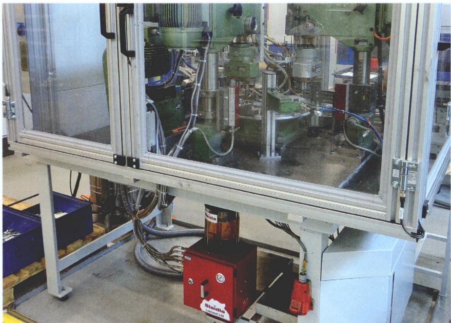
图 2 经过改装的环形加工设备底部为 Steidle 公司 Lubrimat L60 型 MQL 装置，由于采用了这种装置，每个产品可以在 24 h 内制造完成
