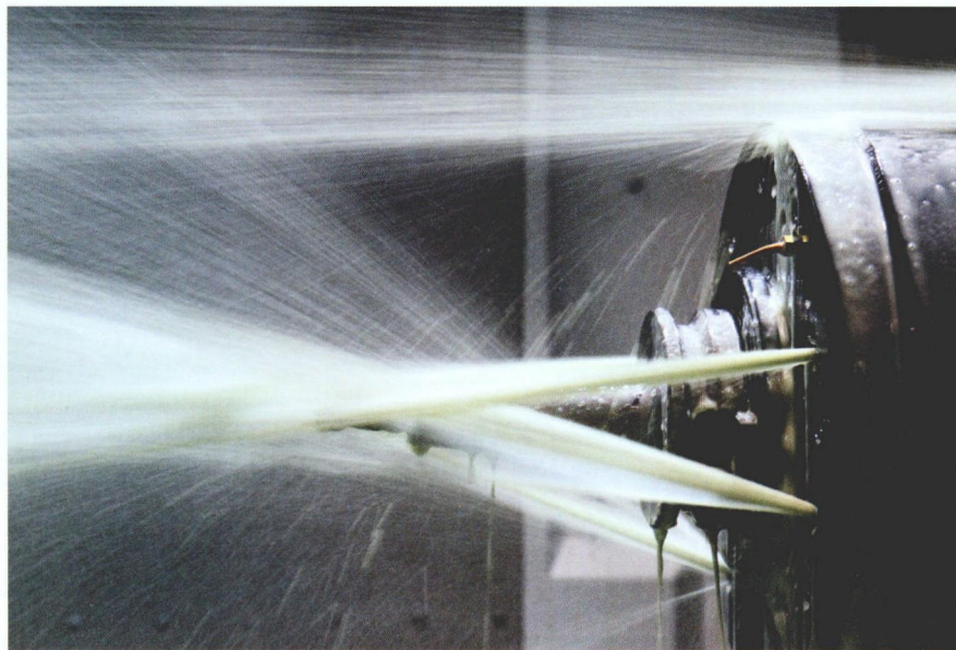
图 2 富勒 SEMC6380 还有很好的消泡性，适合高速加工中心或钻攻中心应用
