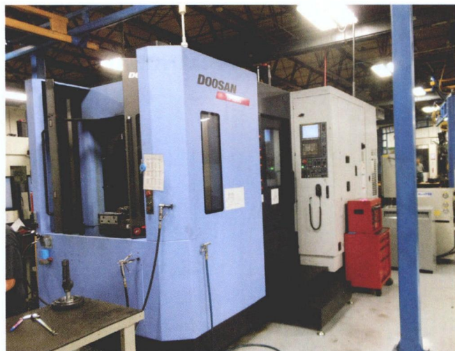
图3 对于冲击力,则使用带BCV50 Big-Plus主轴的Doosan HP5500 HMC和带CAT50主轴的Makino A71 HMC完成钻孔作业
