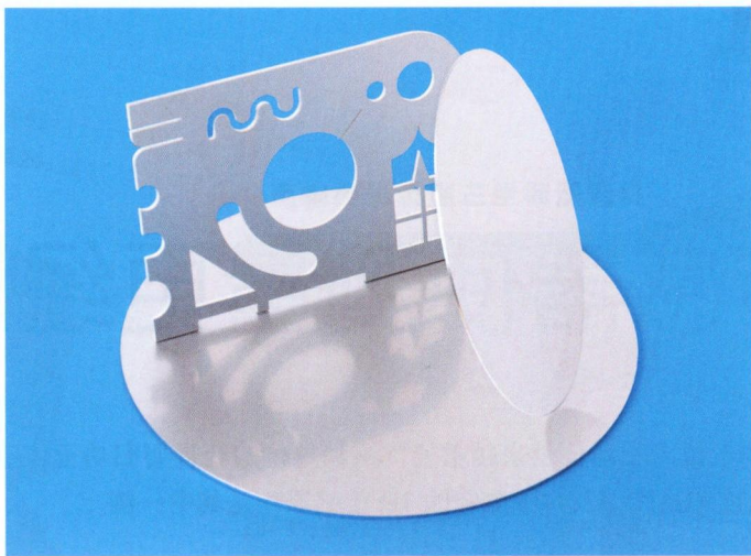
图 4 厚度为 2 mm 的不锈钢测试件, 其切割质量很高, 所加工的复杂外形结构也很精确
