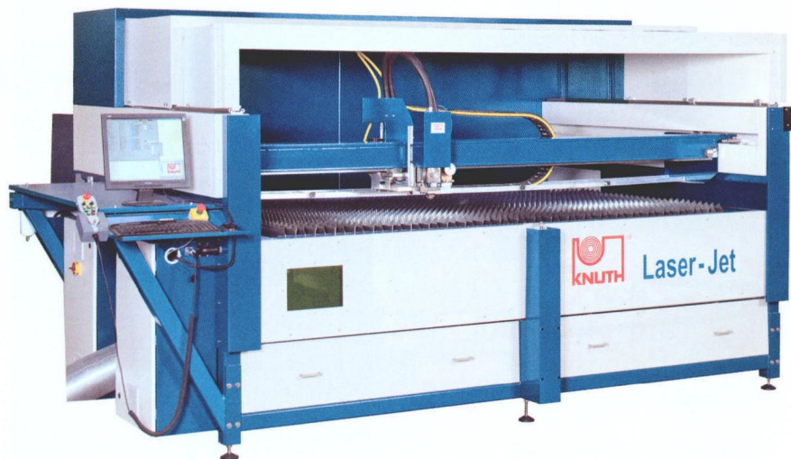
图 2 Laser-Jet 2512 FL 2000 型激光切割设备：上部带有护罩的整体光纤激光切割设备使用非常灵活，其端面元件可以向下摆动，以对作业面进行装载
