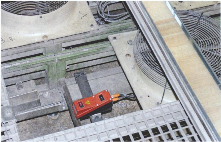
图 4 LRS 36 型传感器的紧凑造型减轻了其在风机之间的安装难度
