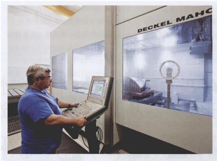
图 1 在大型多轴机床上执行的铣削、直线镗孔和车削作业，这些机床绝大多数都配备了西门子 Sinumerik 840D CNC 装置，用于控制所有运动轴
