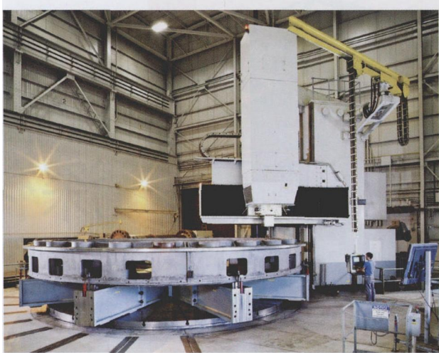
图3 这台大型Ingersoll铣床最近采用全新西门子CNC、电机、驱动器和其他硬件进行了翻新
