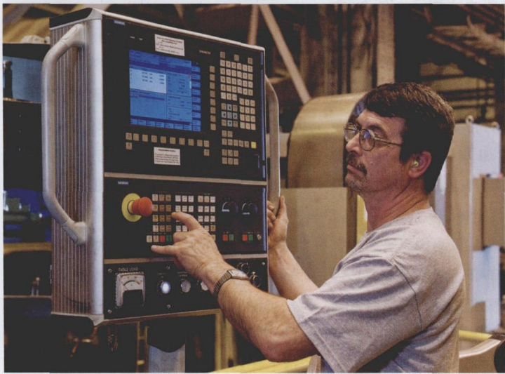
图2 通过机床上配备的CNC，Voith Hydro公司与其众多机床制造商开展了远程状况监测，实时排查故障和解决问题
