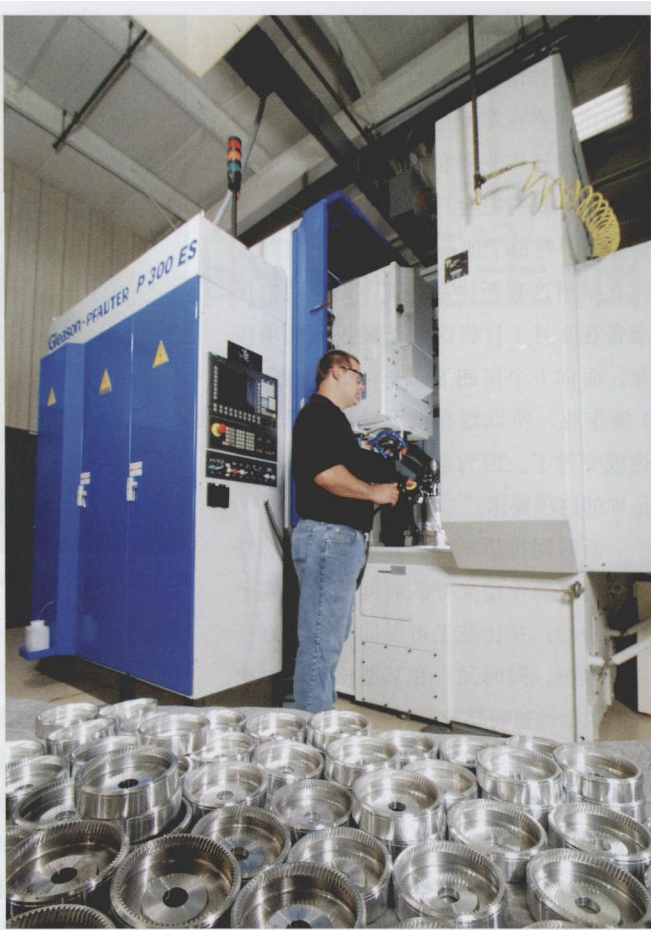
图 2 FCG 车间的机床已经指定用于每一种价值流，因此可以更容易地预测哪一台设备将可用于这两种类型的定制齿轮作业
