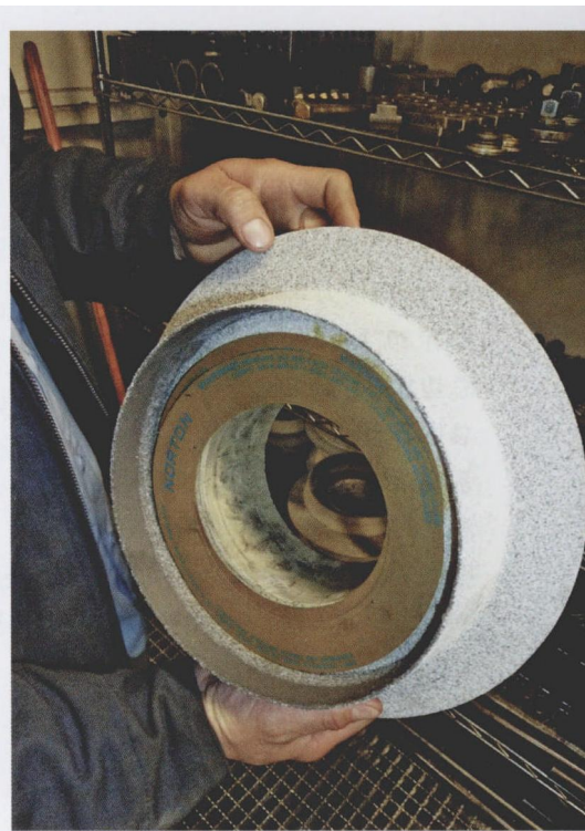
图2 诺顿公司生产的 TG II 研磨轮具有类似于稻米纹路的长且薄的挤压纹理，研磨轮有很好的耐磨性和良好的材料去除能力
