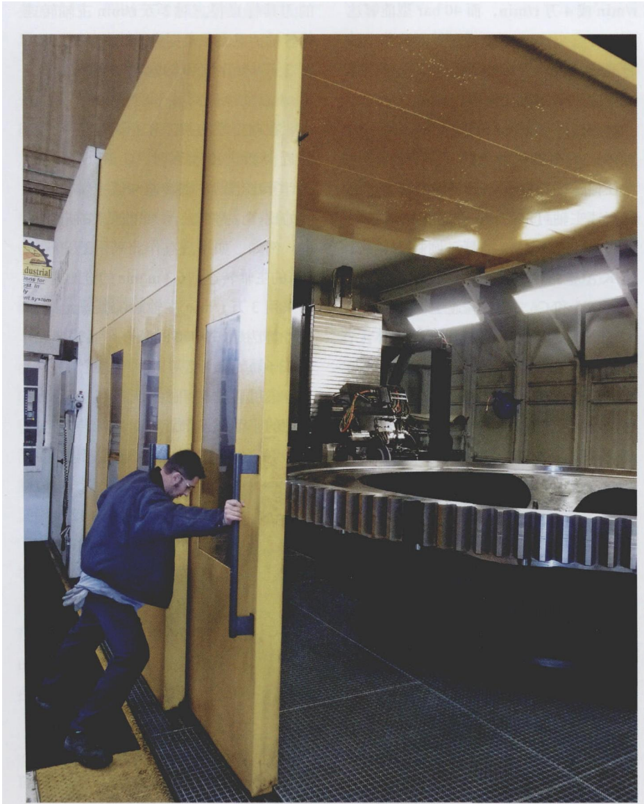
图1 罗利·塔格莱规划并操作公司的 Höfler Rapid 6000 仿形磨床，为矿业贡献了大量的 206 in 的研磨齿轮
