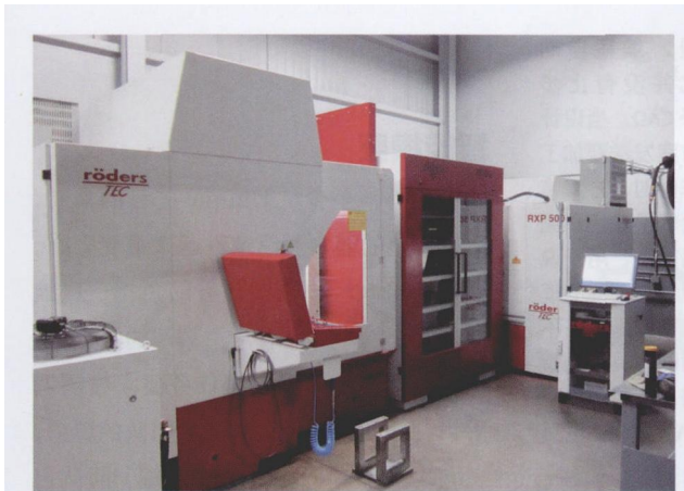
图4 由2台 Roders RXP 500 高速加工中心和同厂家的1台 RCS2 型机器人构成，这款崭新的电极加工单元也包含在这笔 350 万美元的最近设备投资当中
