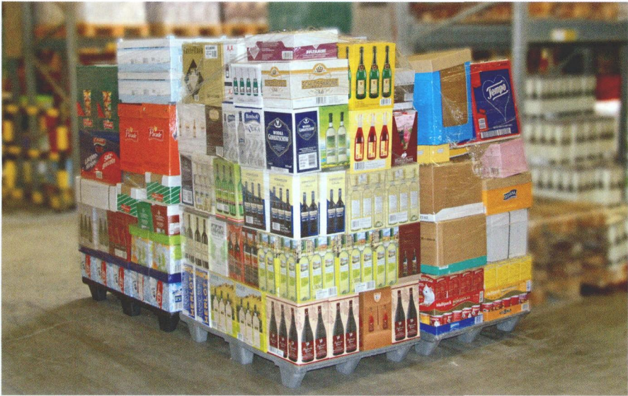
图 2 由可回收利用的人工合成材料制成的装卸货托架自重很小，从而大大提高了承载能力
