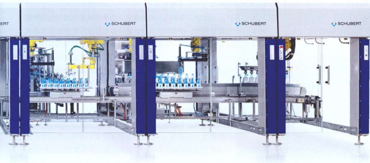
图 1 TLM 液体灌装装置结构紧凑，一台装置集成了所有分功能。图中所示 TLM 液体灌装装置由 8 台分机器组成
