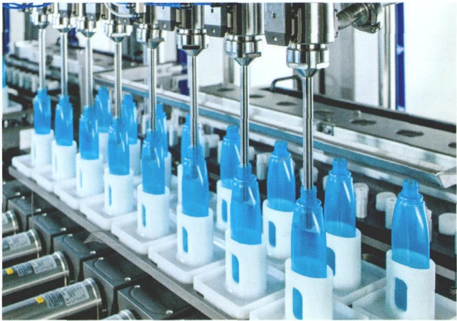
图 4 在液体灌装过程中，液体灌装针可根据所灌装的产品液体进行或高或低的灌装高度调整
