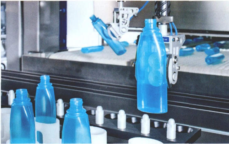
图2由一扫描仪检测抵达的PET化妆品瓶。TLM-F4机器人抓起化妆品瓶并将其放入规格件内
